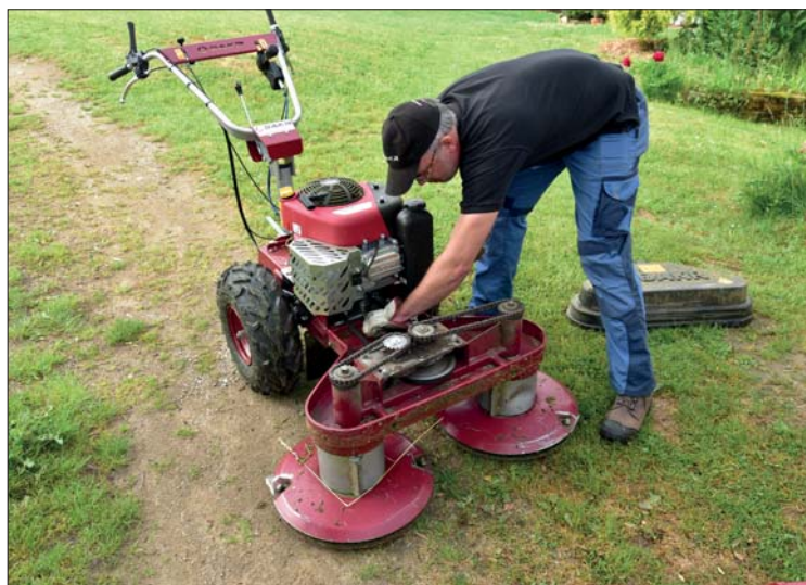
Výměna příslušenství k pohonné jednotce je jednoduchá. Nástavec RZS121 pohání klínový řemen, řetězy a ozubená kola
